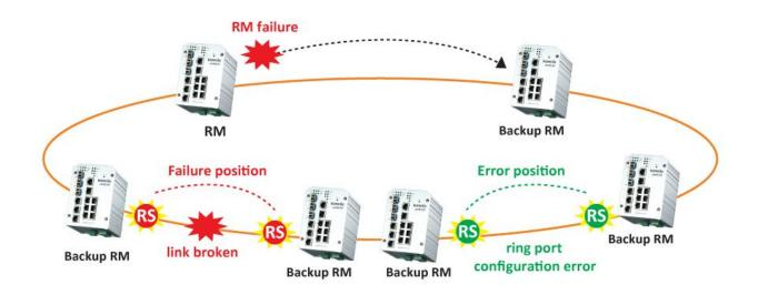
**Trunk Ring**: объединяет магистральные порты и технологию MSR, которая позволяет увеличить пропускную способность со 100М до 1000М и повысить уровень резервирования. Эта технология рекомендуется для приложений, которым требуется высокая пропускная способность.
