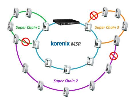
**Резервирование Ring Master**: хотя только один Ring Master (RM) находится в кольце, запатентованная Korenix технология RM резервирование решает критическую проблему и гарантирует, что кольцо всегда хорошо контролируется. Каждый коммутатор, кроме RM, является резервным RM. Один из резервных RM автоматически примет роль RM на себя, немедленно, в случае сбоя основного RM.
