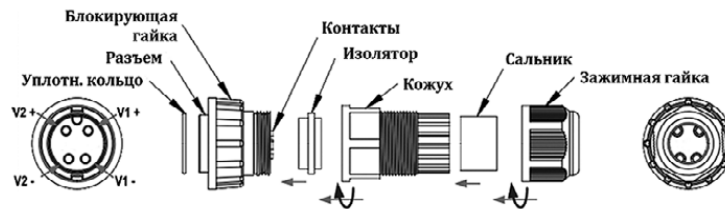
Рисунок 3.1-2 Сборка разъема питания
