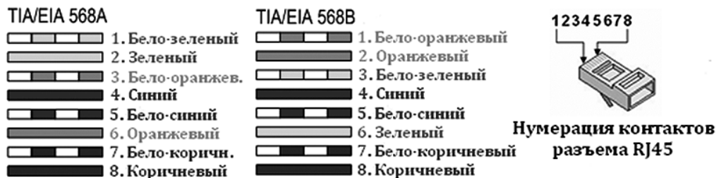
Рисунок 19 Цветовые схемы кабеля RJ45
