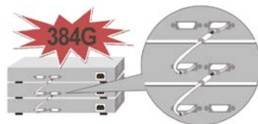
10G интерфейсы с разъемами на задней панели для объединения в резервируемое кольцо
