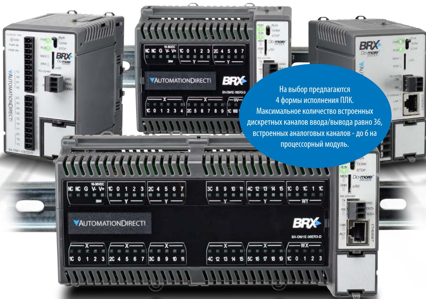
На выбор предлагаются 4 формы исполнения ПЛК. Максимальное количество встроенных дискретных каналов ввода/вывода равно 36, встроенных аналоговых каналов - до 6 на процессорный модуль.
