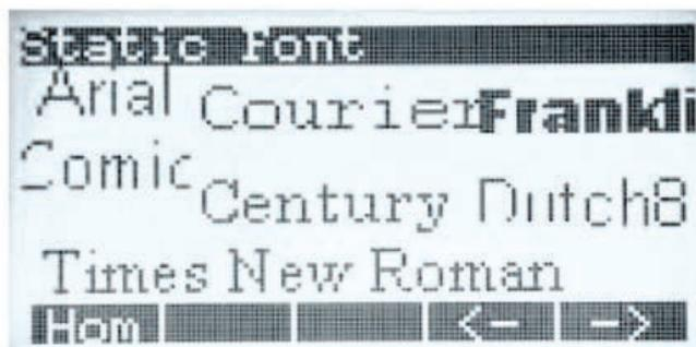
3" модели позволяют разместить на экране 10 строк статического текста по максимум 32 символа фиксированного шрифта «4 x 6» в каждой строке.
