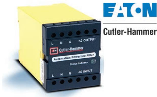
Сетевой фильтр может кратковременно защитить подключенное оборудование от повышенного напряжения на входе. Он устраняет EMI/RFI шумы до того, как они проникнут в вашу систему. Сетевой фильтр может шунтировать всплески тока до 39 000 А (L–N, L–G), причиной которых может быть молния, а также отфильтровывать пики напряжения продолжительностью менее 1 нс.
