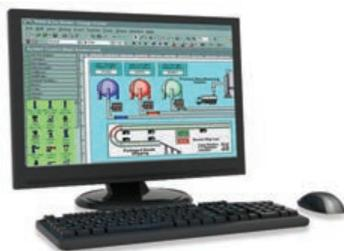
Системы управления на базе ПК со стандартной операционной системой, такой как Windows NT, поддерживают HMI и прогон программы управления, работающей на ПК платформе. Легко доступны любые коммерческие модели и промышленно закаленные единицы. ПК-архитектура позволяет системе бесшовно поддерживать различные сторонние устройства ввода/вывода, системы управления движением и технического зрения и полевые сети.
