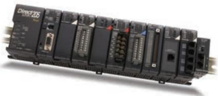
ПЛК преуспевают в последовательной логике и базовом аналоговом управлении. Их модульность и прочность делают их пригодными для широкого спектра приложений автоматизации.
